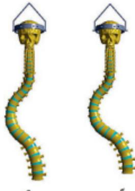
Рис. 1. Розрахункові моделі таза: а) деформація хребта 70°; б) деформація хребта 100°; в) фіксація в системі гало-гравітаційної тракції із фіксацією 6 гвінтами
